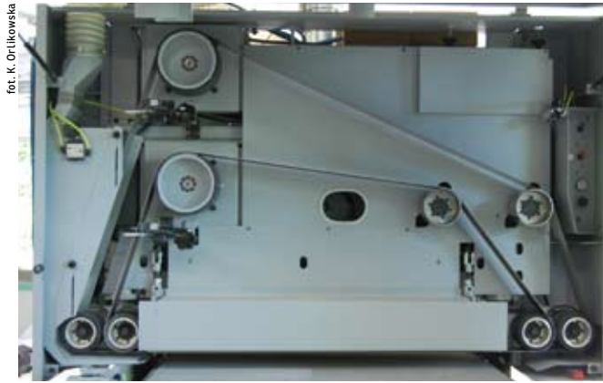
Napęd taśmy ścierniej i sierżanta dociskowego w agregacie poprzecznym Cross-Sanding realizowany jest przez oddzielne silniki, dzięki czemu można osiągnąć jakość szlif i rysy niedostępną dla wielu innych rozwiązań.
