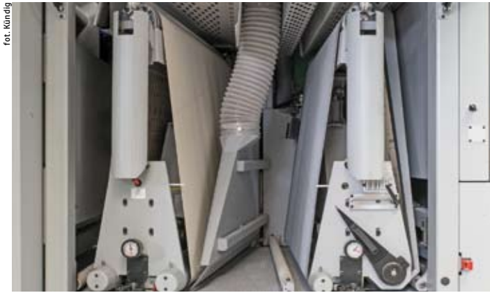
Agregat szlifujący Oblique jest przesunięty w stosunku do transportera o 10 stopni, dzięki czemu zniwelowany zostaje wpływ ubytków powstających na materiale ściernym na jakość szlifowania.
