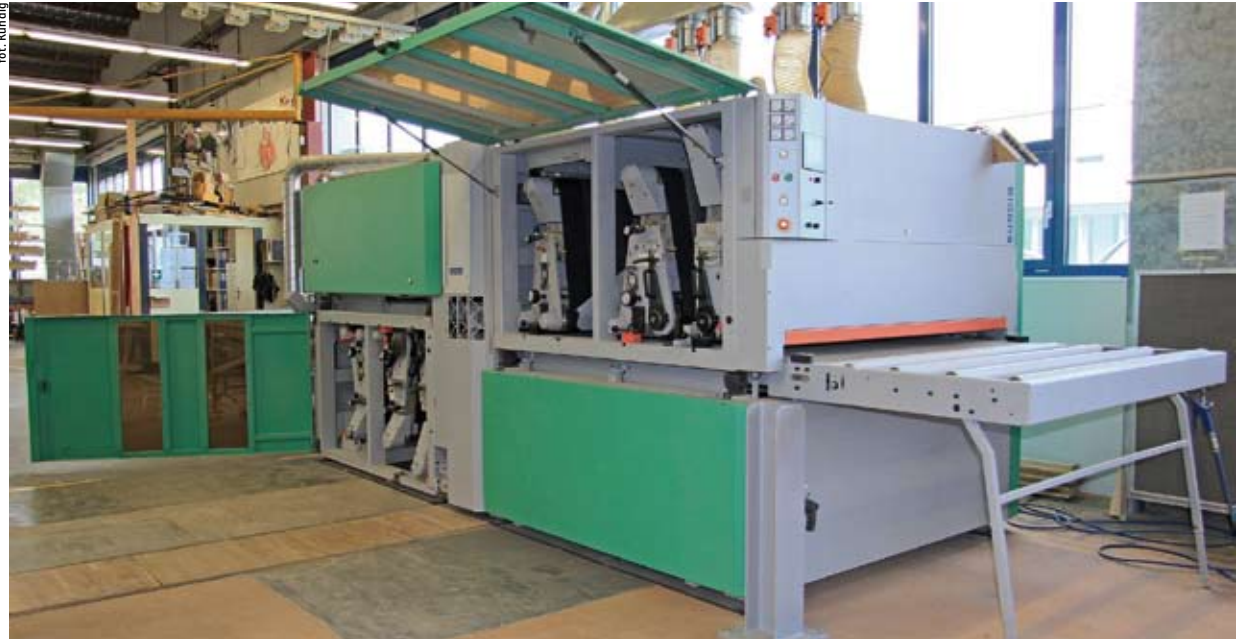
Aby zachować dokładność obróbki, w przypadku największych szlifierek, Kündig stosuje budowę wieloramową.
