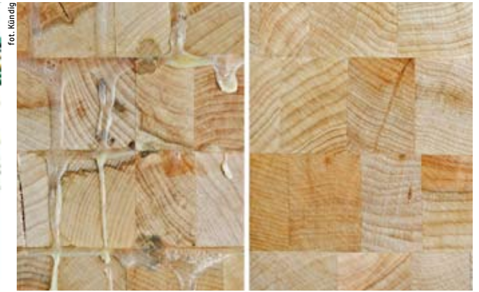
Przykład klejonego elementu przed (zdjęcie z lewej) i po obróbce na szlifierce BoTop.
